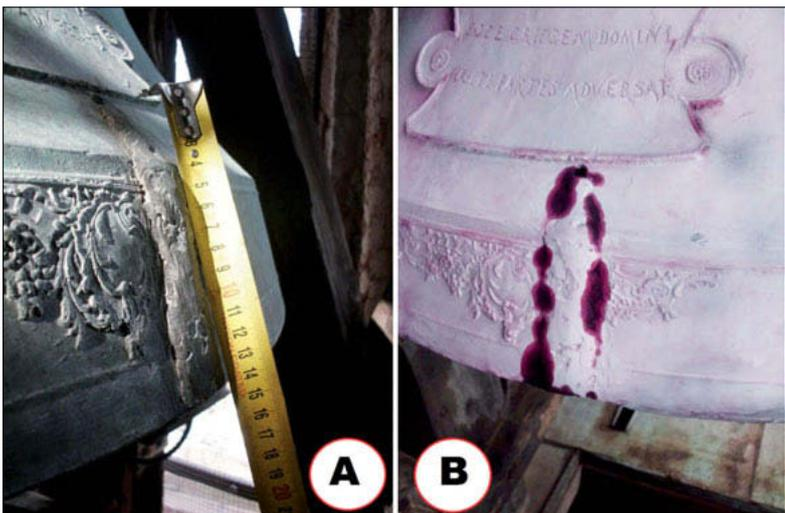
Fig. 8 – Fasi di un intervento di saldatura del vaso sonoro con l'individuazione dell'entità di una crepa (peraltro già in passato saldata) (A) e individuazione dei punti deboli attraverso l'uso di liquidi altamente penetranti, dopo aver detensionato il metallo (colorazione rosea in B).
