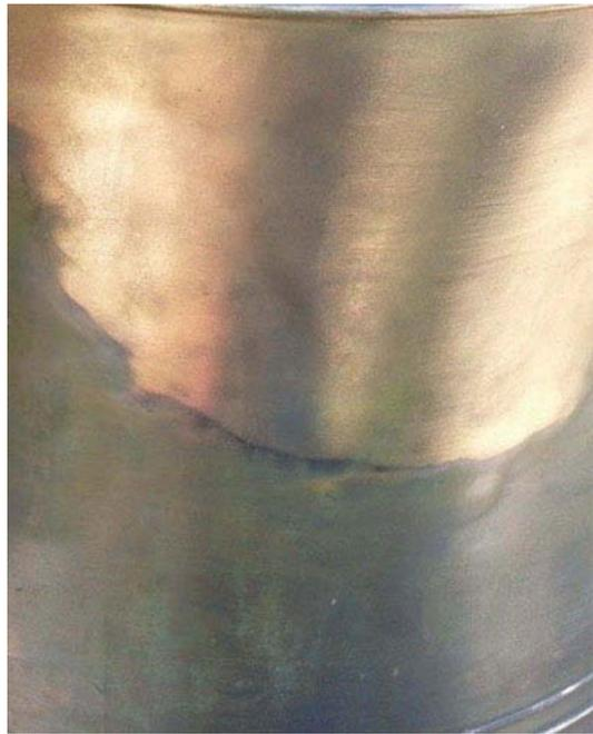
Fig. 4 – Campana sottoposta ad una pulitura invasiva con eliminazione totale della patina.
